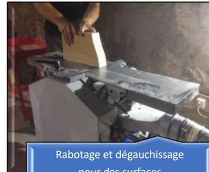
Rabotage et dégauchissage pour des surfaces parfaitement planes
