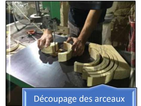
Découpage des arceaux un par un à la scie à ruban
